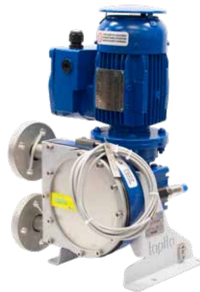
PXTL13 para zona ATEX con conexiones bridadas, cubierta antilluvia para motor eléctrico, sensor de temperatura y detector de fugas de manguera
